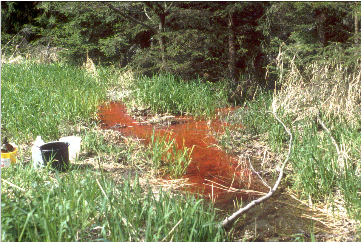
Abbildung 3 Markierung des Rehbachzuflusses am 14.05.1997 mit Sulphorhodamin B und Bromid
